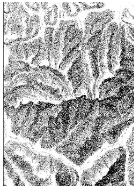
Abb. 5: Die Kartografen verwendeten die Technik der Kreidelithografie, um Relieftöne zu erzeugen (Lehrlingsarbeit, swisstopo).
